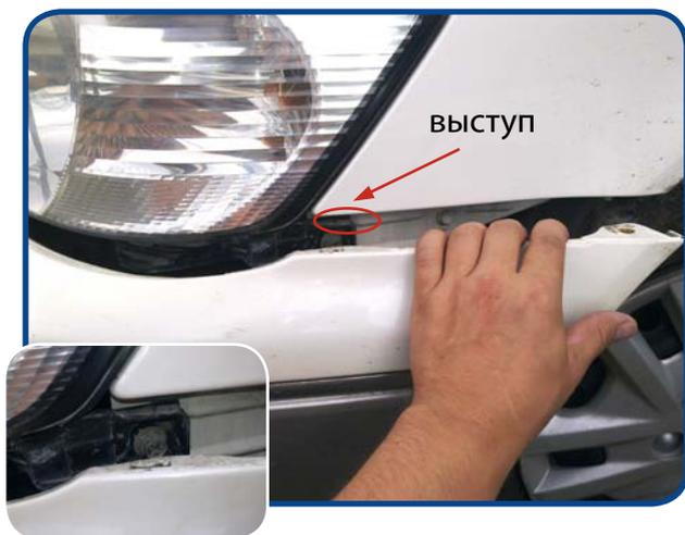
Чтобы увидеть скрытый четвертый болт, который крепит фару, нужно отогнуть край бампера, слегка приподнять его и снять с выступа, указанного на картинке.
